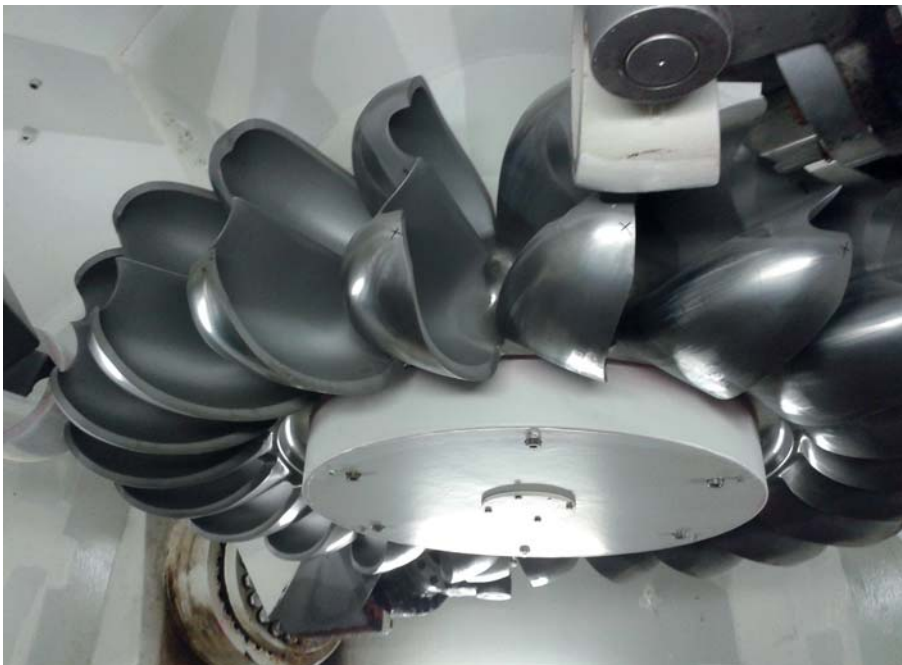
Figure 1 Turbine Pelton de 100MW du groupe 1 de la centrale de Bitsch de l'aménagement de Electra-Massa.
